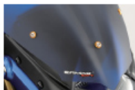
M10 NASAタイプマシンドワッシャー +M10ボルト・ナット使用例
