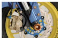
M8 NASAタイプマシンドワッシャー +M8ボルト・ナット使用例
